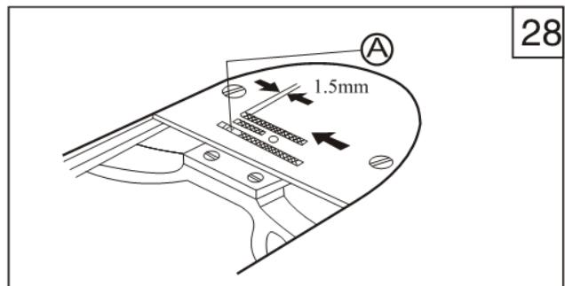
Чтобы отрегулировать позицию зубчатой рейки, переместите зубчатую рейку к передней части игольной пластины, раскрутите винт (A) (См. Рисунок 29b), переместите опору зубчатой рейки B в направлении, показанном стрелкой (Рис. 29a), чтобы выполнить регулировку. После регулировки затяните винт (A).
