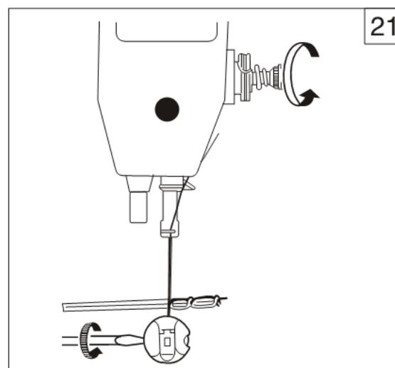
(b). Если натяжение игольной нити слишком слабое или натяжение шпульной нити слишком сильное, поверните гайку с накаткой для регулировки натяжения по часовой стрелке, чтобы немного натянуть игольную нить или поверните винт регулировки натяжения шпульного колпачка против часовой стрелки с помощью небольшой пластиковой отвертки, чтобы немного ослабить натяжение шпульной нити (Рис. 22).
