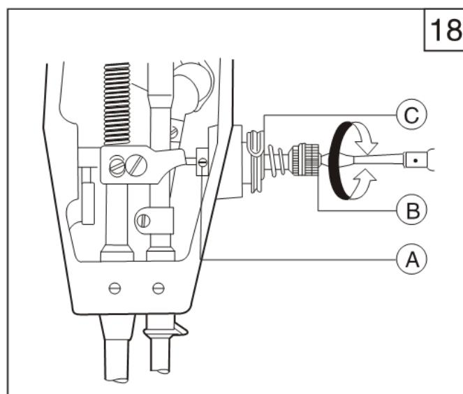
винт натяжения (B) против часовой стрелки на  $\frac{1}{2}$  поворота. После регулировки затяните установочный болт (A) винта натяжения.
