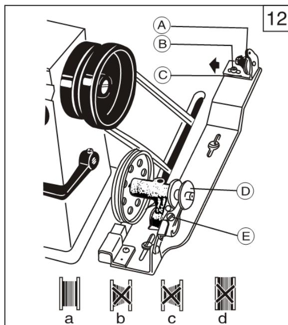
Примечание: нейлоновую или полиэстеровую нить необходимо наматывать при небольшом натяжении, в противном случае шпулька (D) может поломаться или деформироваться.
